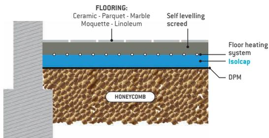
**BETWEEN FLOORS: LIGHTWEIGHT FILLING LAYER FOR UNDERFLOOR HEATING SYSTEM OF VAULTED SLABS**
