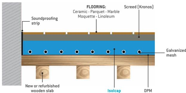
**SPECIAL APPLICATION: LIGHTWEIGHT THERMAL INSULATING LEVELLING-FILLING OF VAULTED SLABS**
