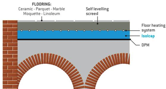
**BETWEEN FLOORS: LIGHTWEIGHT FILLING LAYER FOR UNDERFLOOR HEATING SYSTEM**
